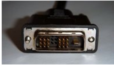
DVI-D-Kabel, Stecker ist um 180° gedreht
