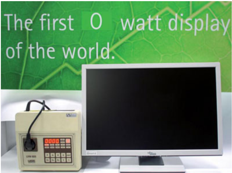
Dank neuartigem Netzteil verbrauchen die ECO-Monitore keinen Strom im Stand-by (Bild: FSC)
