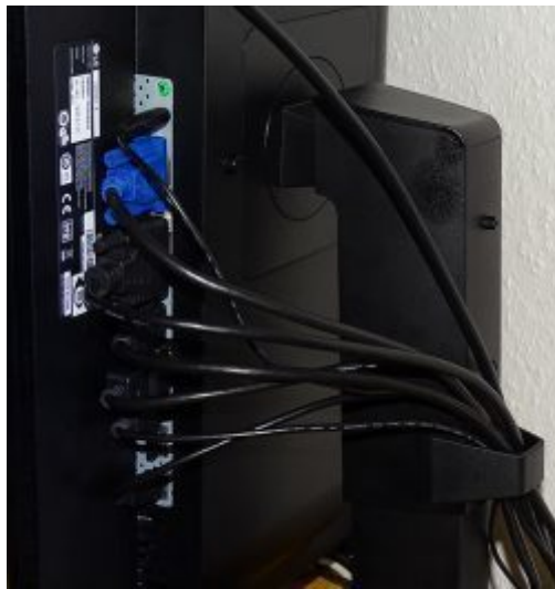
Die Kabelhalterung ist zwar gut dimensioniert, springt beim Drehen des Monitors manchmal aber einfach ab
