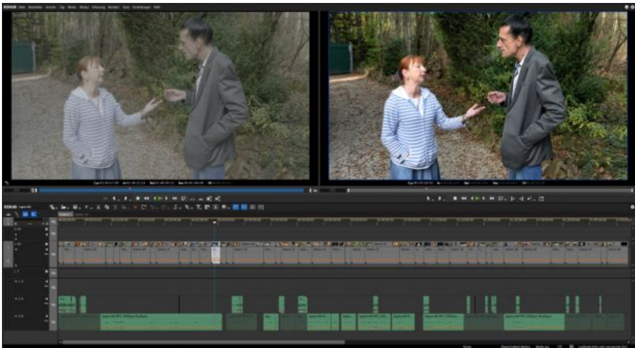
Darstellung eines Videos in Edius. Direkt aus der Kamera (links) und nach Zuordnung einer 3D-LUT und kleineren Farbanpassungen (rechts)
