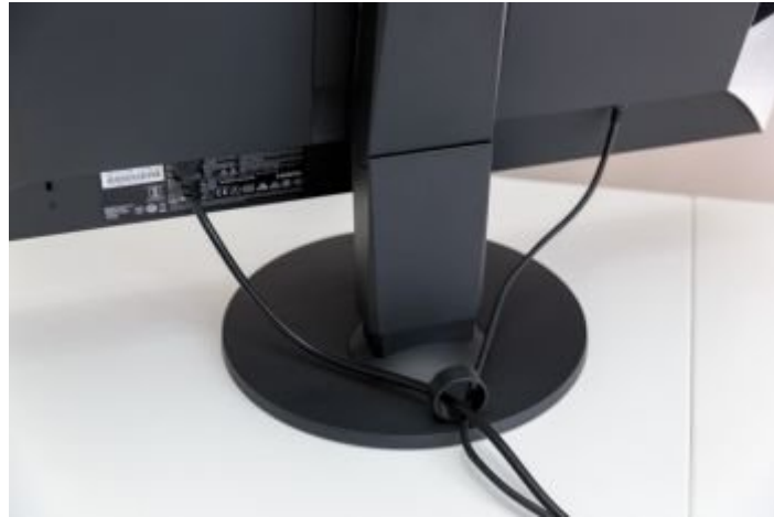
Der Kabelhalter erlaubt kein ordentliches Kabelmanagement
