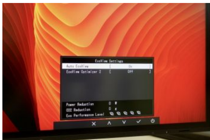
Mithilfe der Auto-EcoView-Funktion passt der EV3285 die Bildschirmhelligkeit automatisch an die
