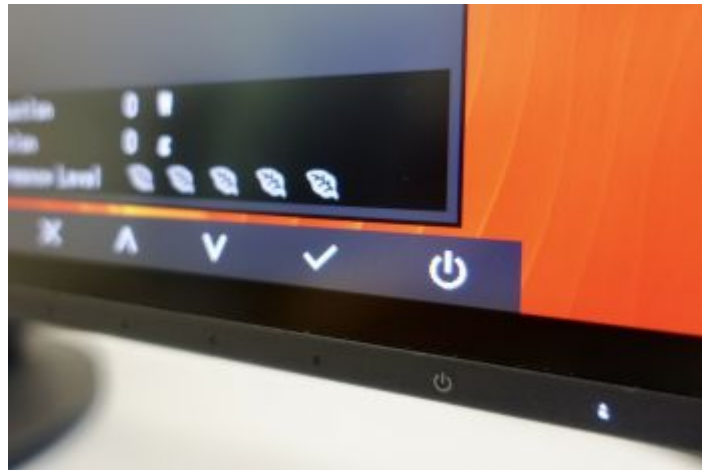
Die Bedienung des OSDs erfolgt über sieben berührungsempfindliche Taster an der Vorderseite des Geräts
