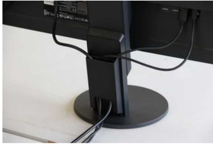
Kabelbündelung mit Blende
