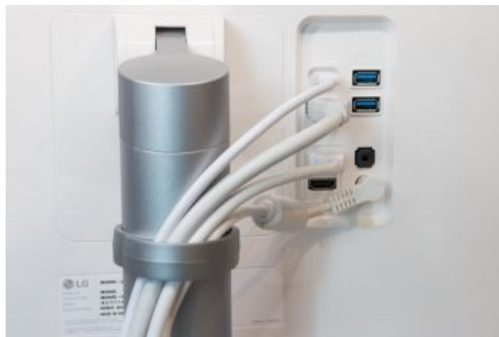
Die Kabel lassen sich mit dem Plastikclip vor oder hinter dem Standfuß platzieren
