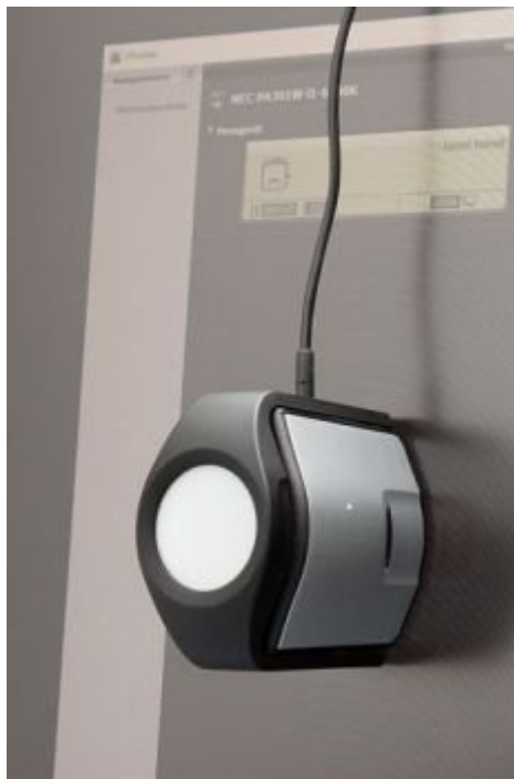
Kolorimeter muss komplett flach auf der Oberfläche aufliegen
