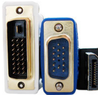
Größenvergleich: DVI, VGA und DP (Foto: displayport.org)
