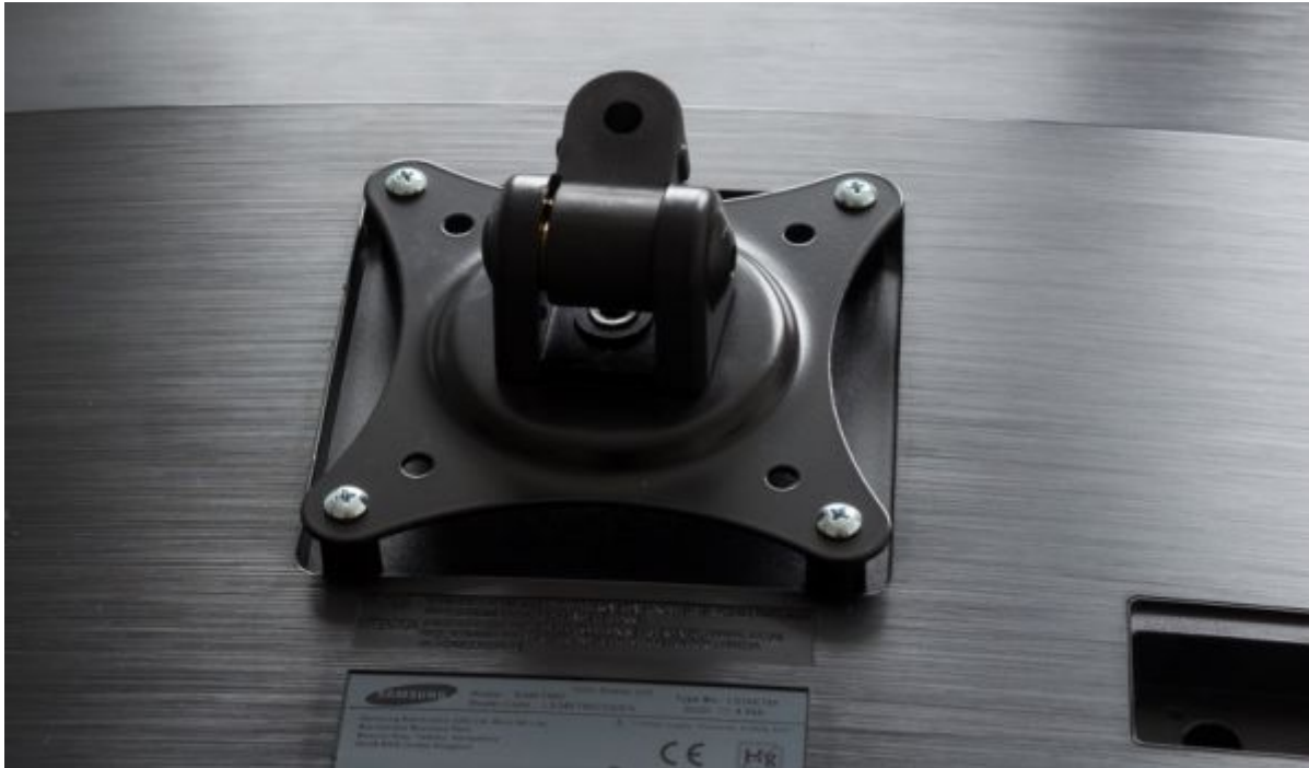
Befestigter Monitor über VESA-100-Bohrungen
