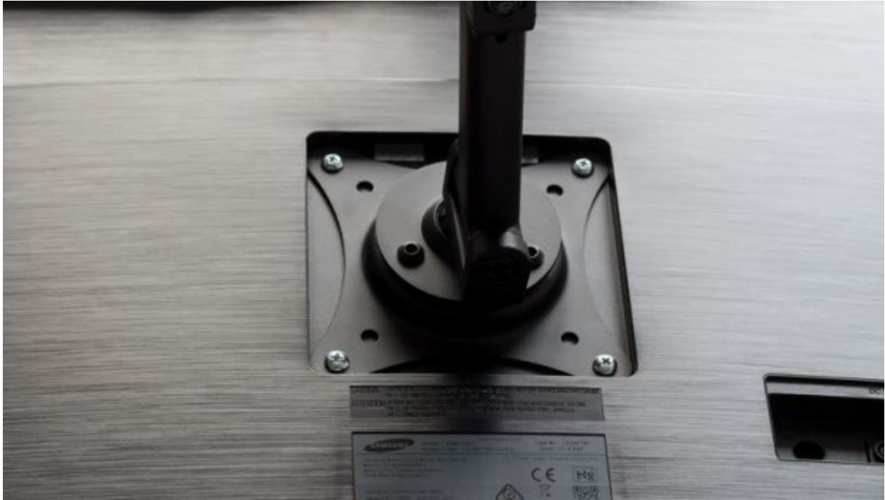
Befestigter Monitor über VESA-100-Bohrungen
