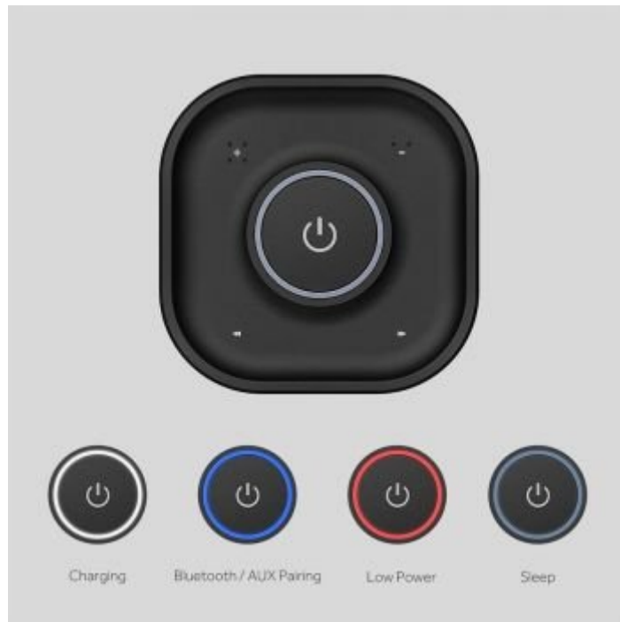
LED-Ring auf der Oberseite signalisiert verschiedene Betriebsszenarien (Bild: EasyAcc)
