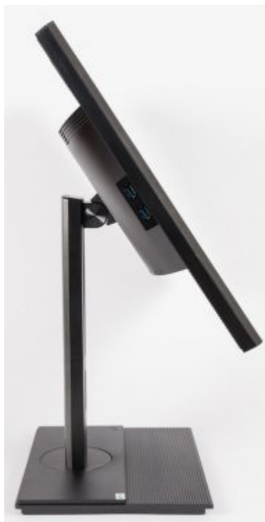
Minimale und maximale Neigungseinstellung.
