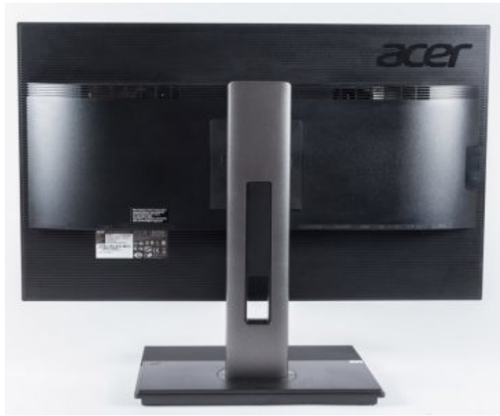
Rückseite mit Standfuß an den Vesa-100-Bohrungen.
