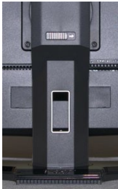
Höhenverstellung voll ausgenutzt und Sicherungstaste auf der Gehäuserückseite
