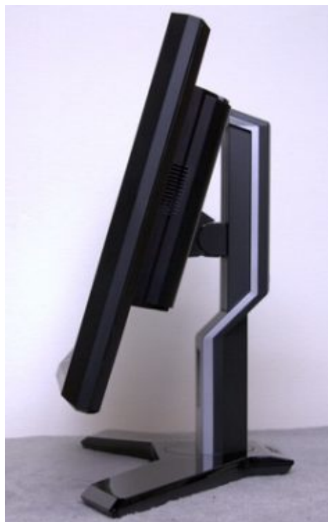
Maximale Neigungswinkel nach vorne und hinten
