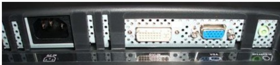
Von links nach rechts: Stromanschluss, DVI-Eingang, D-Sub Eingang, Lautsprecheranschluss
