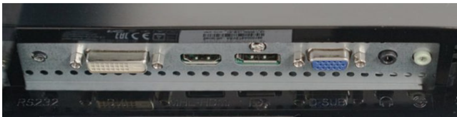
Eingänge: DVI, HDMI, DisplayPort, D-Sub und Audio.
