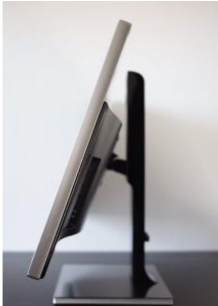
Seitliche Ansicht: USB-Hub und Neigungswinkel von -5^\circ bis 24^\circ .
