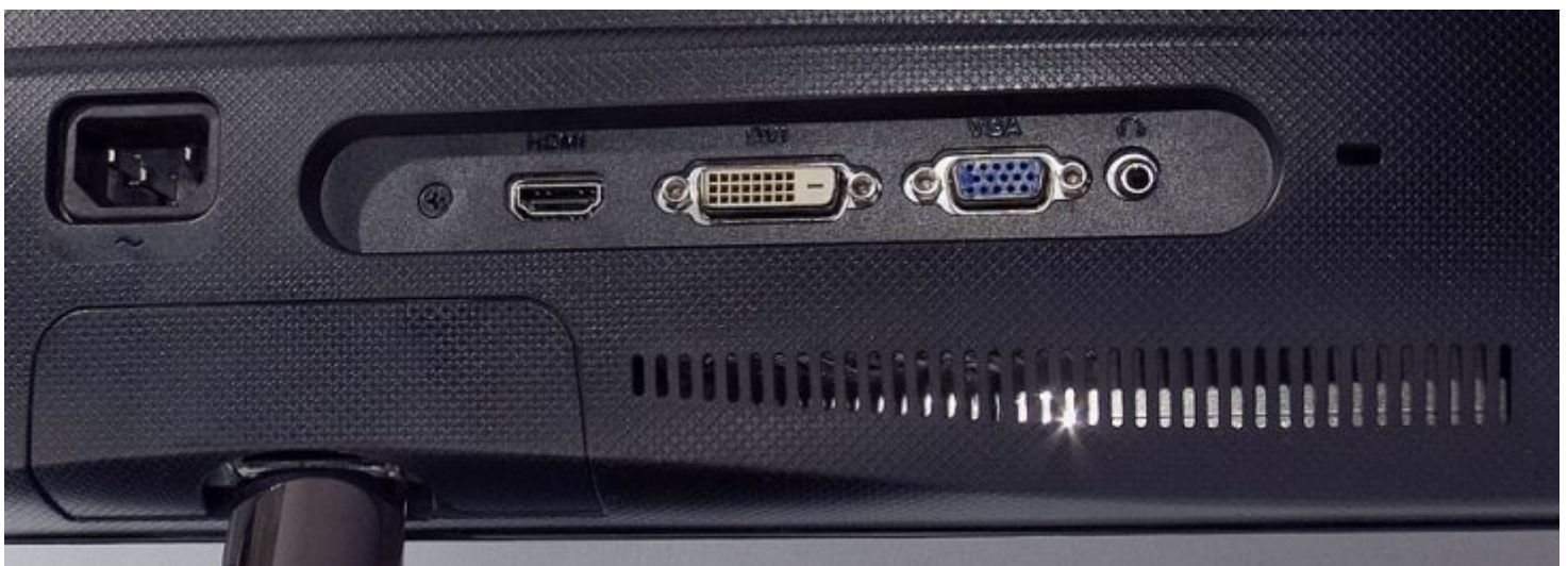
Anschlüsse, Belüftungsgitter und Sichtblende für das Tragarmgelenk.
