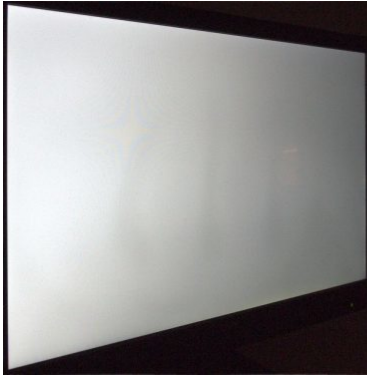
Beim Weißbild werden Verarbeitungsfehler sichtbar.
