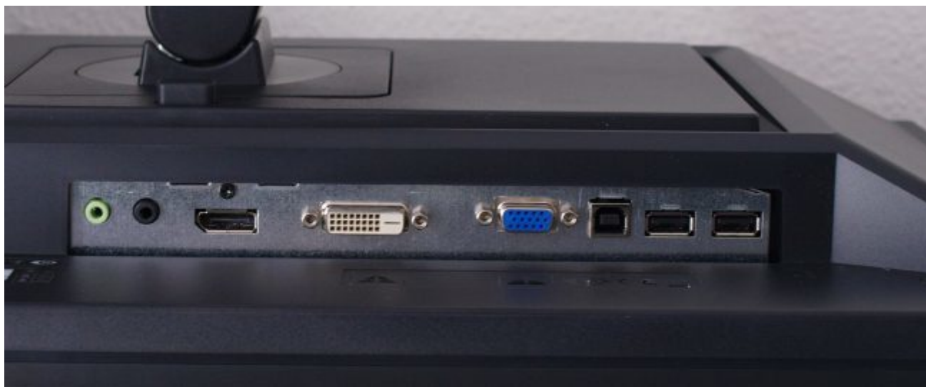
Vertikal angebrachte Anschlussleiste des BL2410PT.
