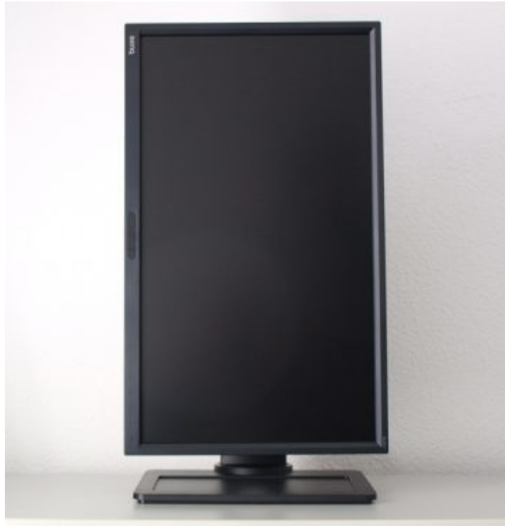
Pivot Stellung - Gelenk nicht vollständig präzise.
