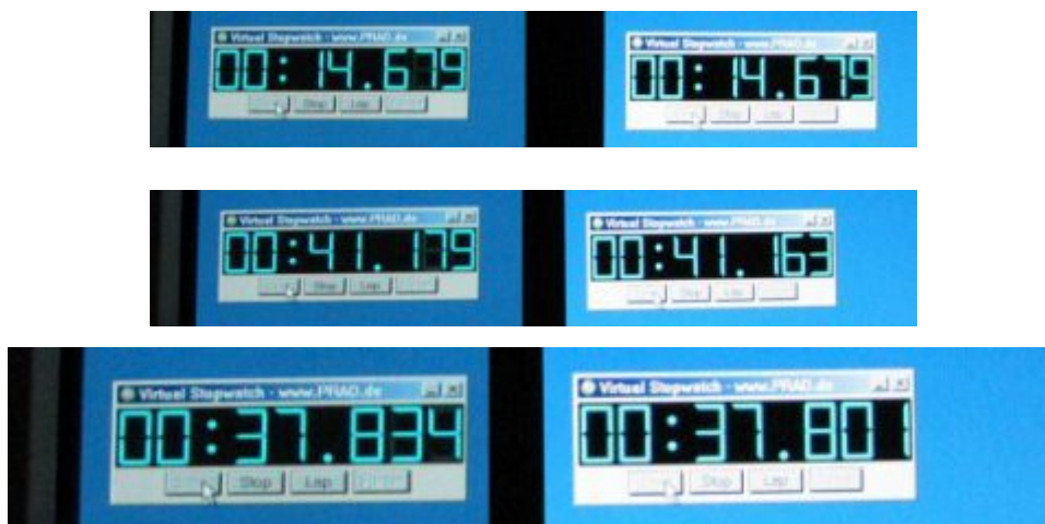
Links ein 21" CRT, rechts der BenQ V2400W. Von oben nach unten ein paar der erhaltenen Messwerte: 0 ms, 16 ms, 33 ms.
