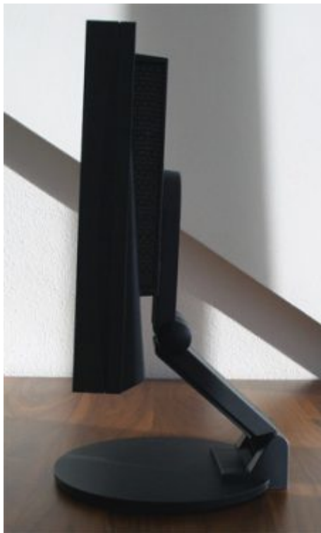
Eizo S2231WE-BK Neigungswinkel und seitliche Darstellung. Gut erkennbar sind die großen Lüftungsschlitze.
