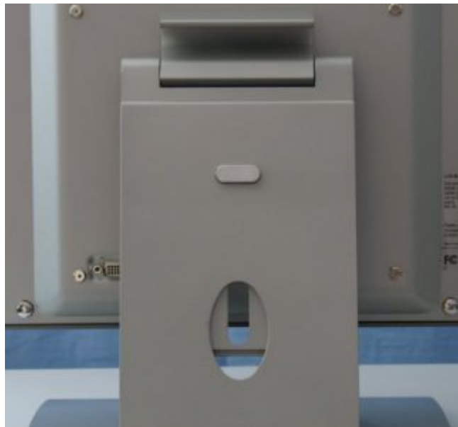
Bild der Höhenverstellung: gut erkennbar der Griff und der Kopf zum Lösen der Arretierung
