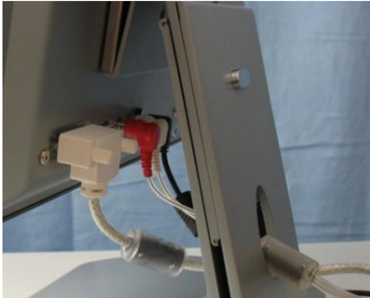
Detailbild der Kabelführung und der Kabel mit den um 90° abgewinkelten Steckern
