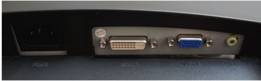
Anschlüsse von links nach rechts: Netzstecker, DVI-D, D-Sub und Audio
