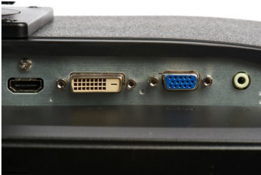
Anschlüsse Iiyama B2475HDS: HDMI, DVI-D, D-Sub und Audio (von links nach rechts).
