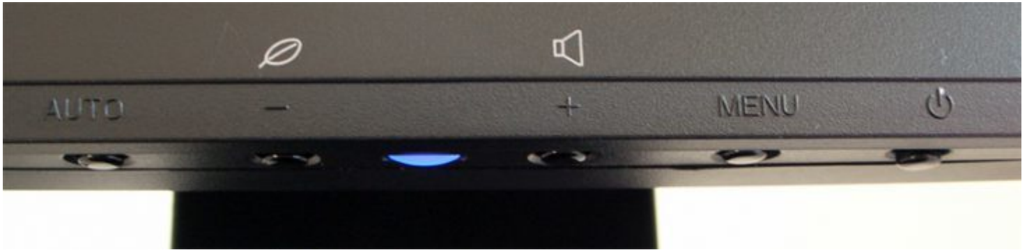
Iiyama B2475HDS: Bedienelemente und blaue Betriebs-LED.
