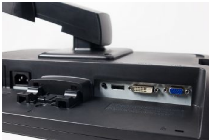
Transportsicherung des 23MB35PY und Anschluss für ein alternatives Standbein.
