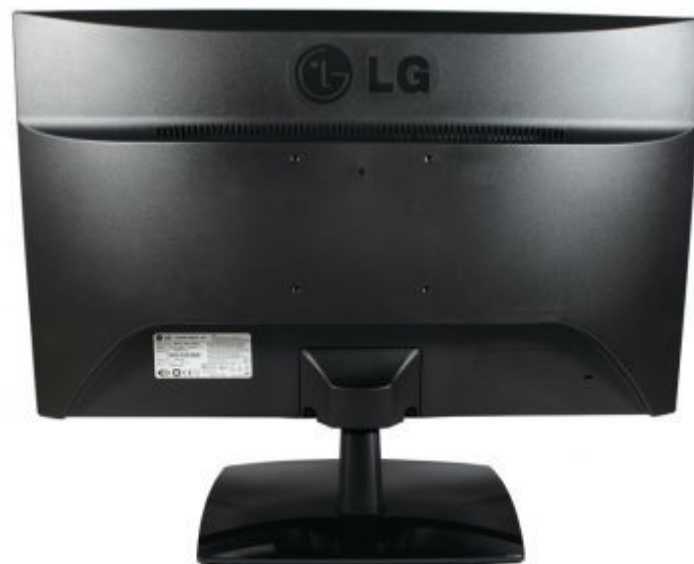
Rückseite des LG IPS235V mit VESA 100 Bohrungen.
