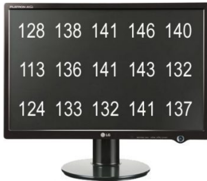
Gemessene Ausleuchtung bei einer Helligkeitseinstellung von 141 cd/m 2 in der Mitte.nn
