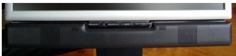
Soundbar am TFT montiert.
