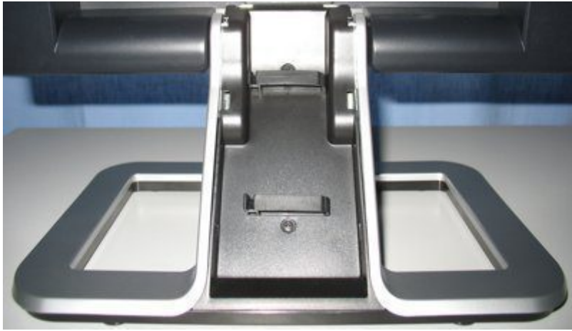
Blick in die geöffnete Kabelführung mit den zwei Kabelklemmen
