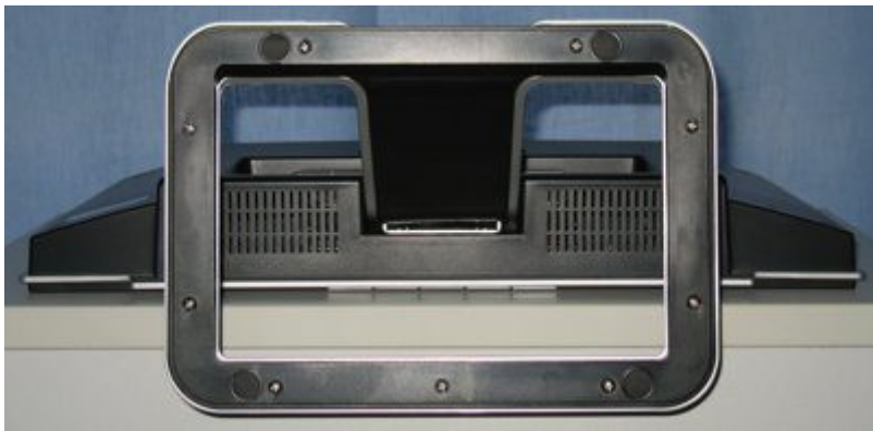
Fuß und untere Lüftungsschlitze. Hinter den Lüftungsschlitzen verbergen sich auch die integrierten Lautsprecher des VX2025wm.
