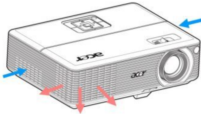
Die Kühlluft durchströmt den Projektor diagonal.
