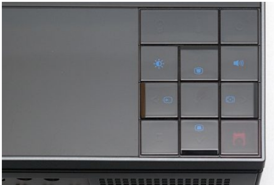
Bedientasten auf der Oberseite des Projektors.
