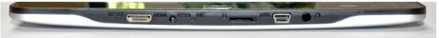
Alle Anschlüsse liegen auf einer Seite.
