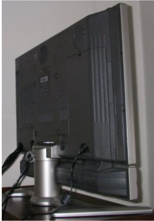
Sharp LC-GA3E von der Seite. Die Tiefe ohne Fuß beträgt 100 mm.
