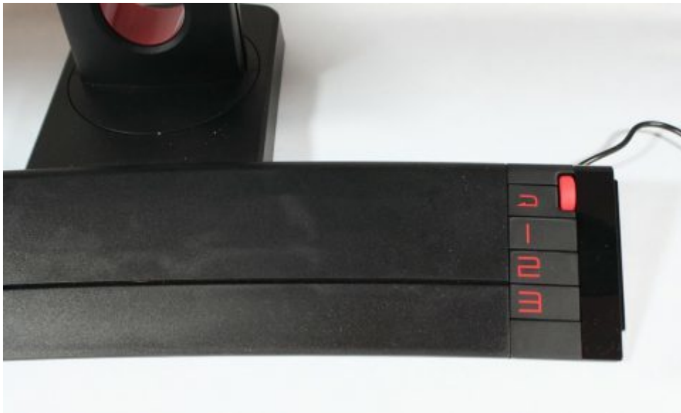
BenQ XL2420T: Switch zur Steuerung des OSDs kann am Standfuß befestigt werden.
